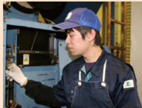
結束機のゴミ詰まりなどを確認
